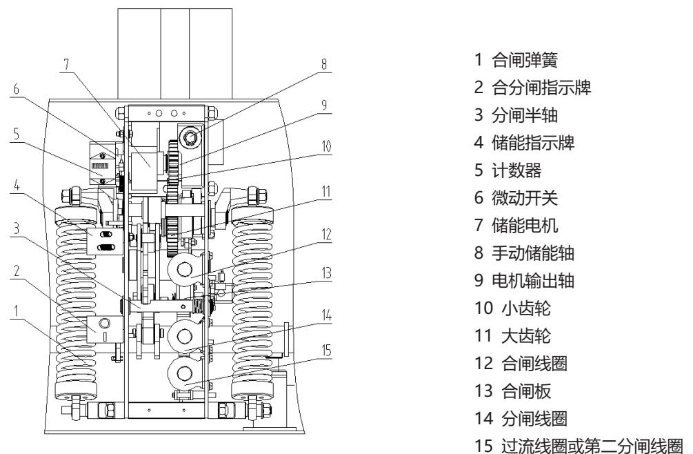
图1 断路器操作机构正视
