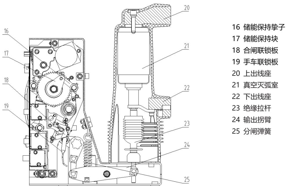
图2 断路器操作机构侧视
